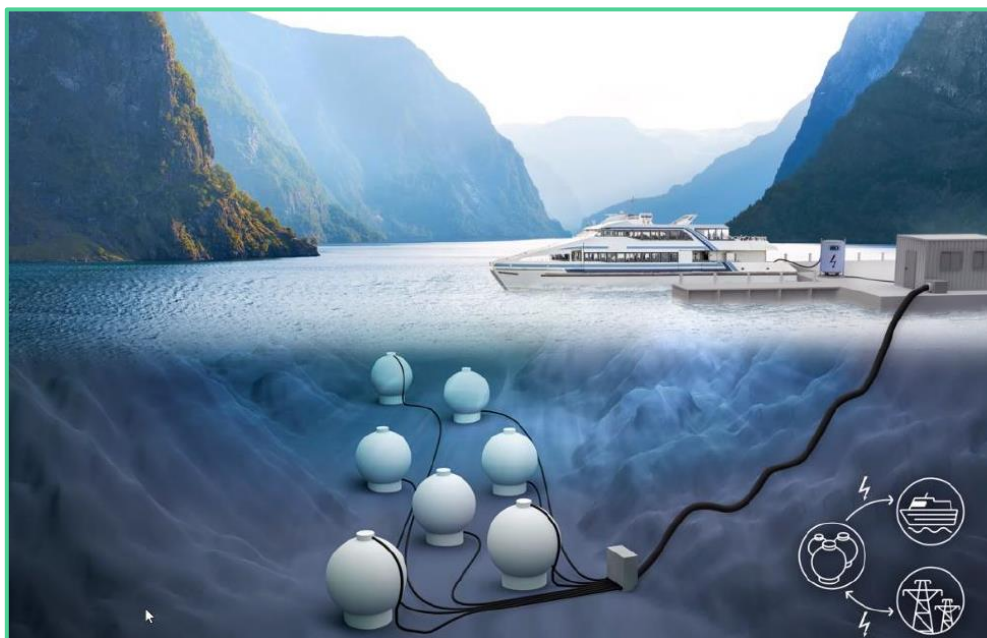
Figur 42. Illustrasjon av Fraunhofer sine StEnSea energilager på havbotnen. Golmen m. fl. (2024).
