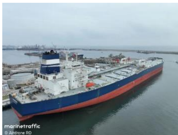
Figur 37. Suez-max skip, tankbåt 'Seavigour'. Lengde 274 m, breidde 48 m, Høgda på skipet er 68 m, frå kjøl til topp. Foto: Marinetrassic.
