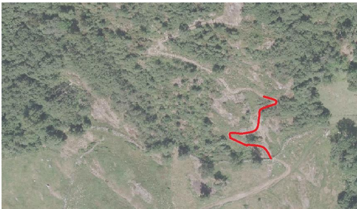
Figur 45. Når stien forlater innmarka på Vesterås kommer et lite parti med dels naturlig berg og dels naturlig jordsmonn (grus/stein/mineraljord) som eroderes, markert med rødt (jf. figurene 24-27). Dette tilsvarer strekninga 4-5 i figur 44 og tabell 6. På deler av, eller hele dette partiet kan det vurderes oppgrusing, steinhellelegging og/eller steintrapp.
