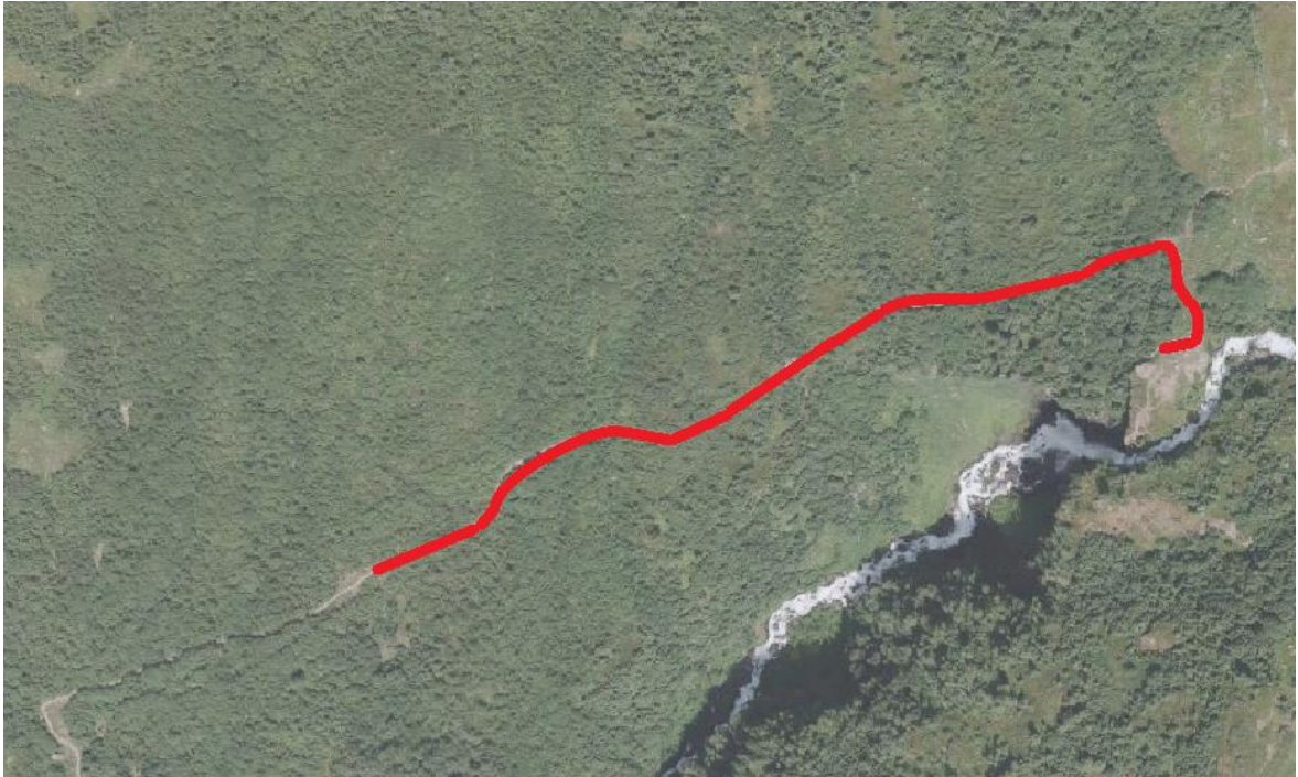
Figur 46. Mellom Liastølen og Storsæterfossen er en strekning på knappe 400 m hvor stien går på naturlig jordsmonn (grus/stein/mineraljord) som eroderes, markert med rødt (jf. figurene 32-36). Dette tilsvarer strekninga 6-7 i figur 44 og tabell 6. Situasjonen med erosjon bør overvåkes. På deler av (eller hele) dette partiet kan det vurderes grusing, steinhellelegging og/eller steintrapp.
