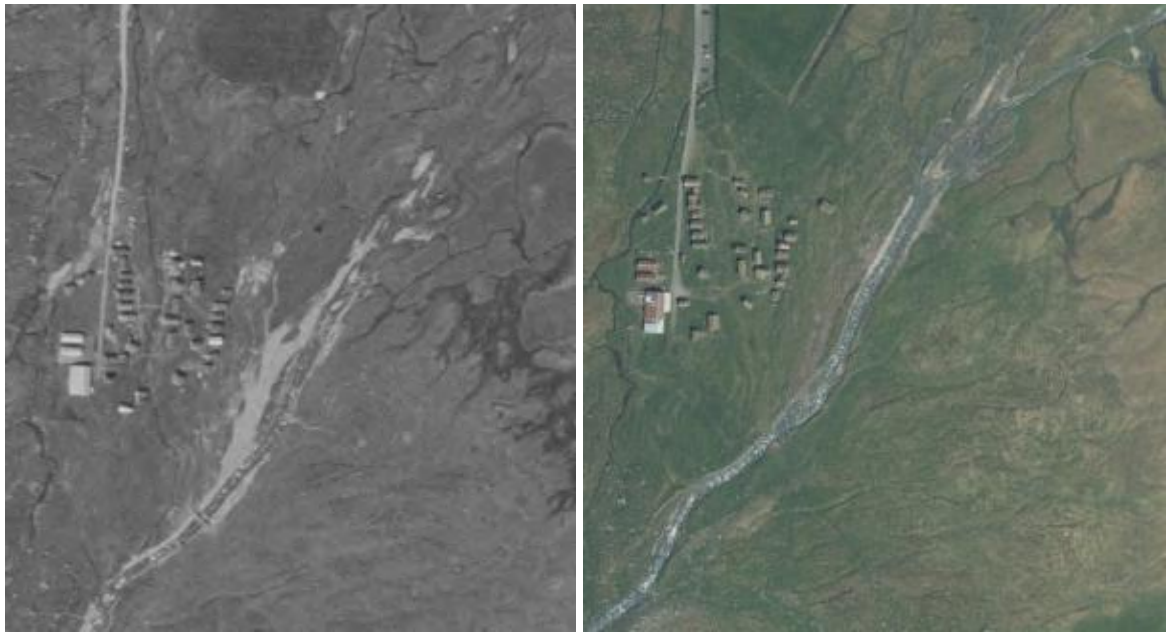
Figur 37 Flyfoto frå 1966 (t.v.) viser at noko kanalisering/elveforbygging alt var gjennomført ovanfor og nedanfor brua. Det lyse langs kanalen viser opprinneleg elveløp og blottlagte område. Flyfoto til høgre er same område frå 2018. Den naturlege flompåverknaden og den meanderande effekten i denne delen av elveløpet er redusert lenger nedover frå brua. Eventuell restaurering av elva er ikkje vurdert i denne rapporten.
