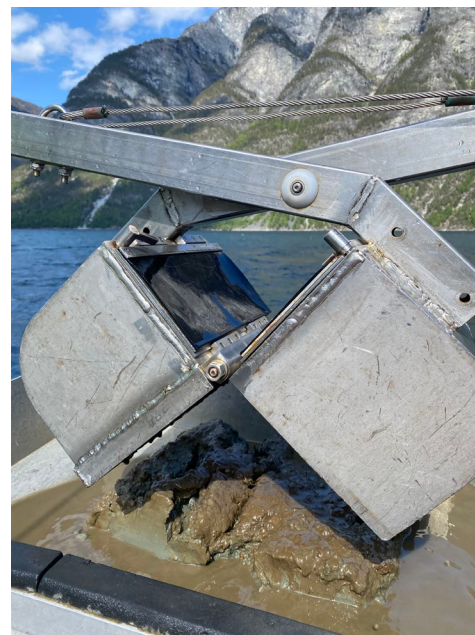
Figur 4. Van veen-grabb som ble benyttet for prøvetaking av bløtbunnsfauna, her i Sognefjorden. Foto: Hilde Trannum
